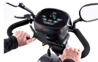
Einhandbedienung durch spezielle Fahrhebelwippe möglich!
